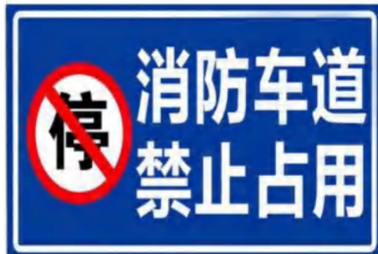
附图 2.1.11-5: 消防车通道禁止占用警示牌示例
