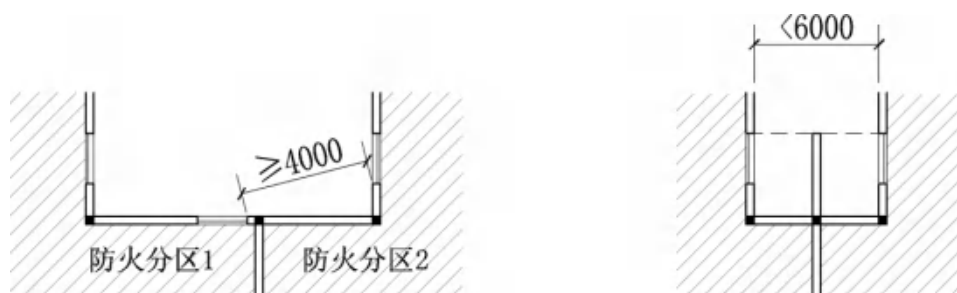
附图 2.3.15 不同防火分区 U 型、L 型公共建筑防火间距
